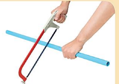
ตัดท่อตามเครื่องหมายที่ขีดเอาไว้
